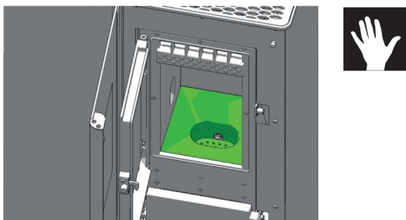
Lors du nettoyage (avec la brosse), faites attention à ne pas endommager l'allumage. Aspirez régulièrement le tuyau d'allumage et degagez à l'intérieur les dépôts de poussière.
