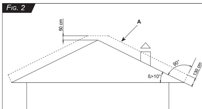
En cas de rafale de vent, si le chapeau de cheminée est placé dans la zone de reflux de la couverture (voir Fig. 2, zone délimitée par la ligne pointillée A pour toitures avec inclinaison  $\beta > 10^\circ$ ) sans avoir respecté les distances suivant la norme UNI 10683, il peut se produire que de l'appareil n'arrive pas à fonctionner normalement.
