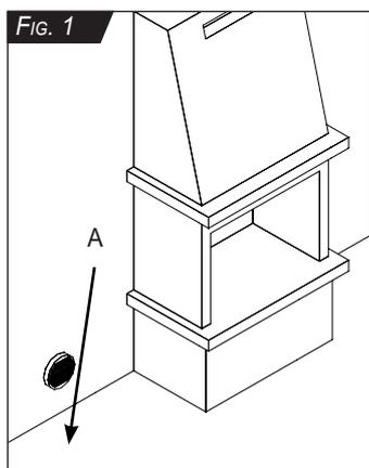
**2b) Prélèvement de l'air de combustion à l'arrière du poêle et directement de l'extérieur au moyen d'un tuyau d'au moins Ø100 mm (modèles 68, 80 et 90) et d'au moins Ø80 mm (modèles 62).**
