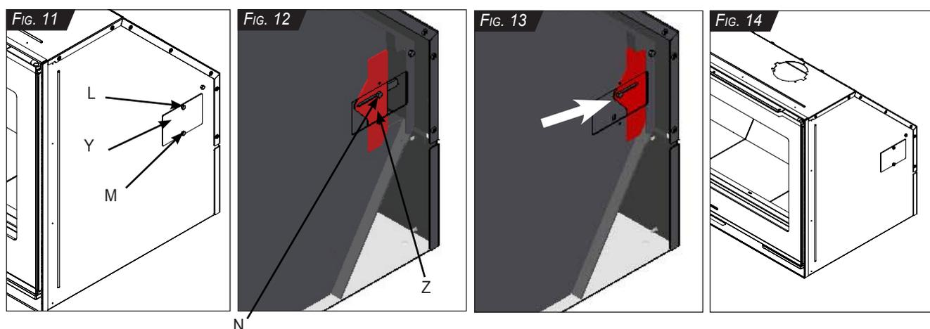
c4) Prévoir une ouverture communiquant directement avec l'extérieur (minimum  $\varnothing 100$  mm pour les modèles 90, 80 et 68 et minimum  $\varnothing 80$  mm pour les modèles 62) afin de connecter le tuyau (minimum  $\varnothing 100$  mm pour les modèles 90, 80 et 68 et minimum  $\varnothing 80$  mm pour les modèles 62) d'un côté au collier (X) et de l'autre à la prise d'air communiquant directement avec l'extérieur.
