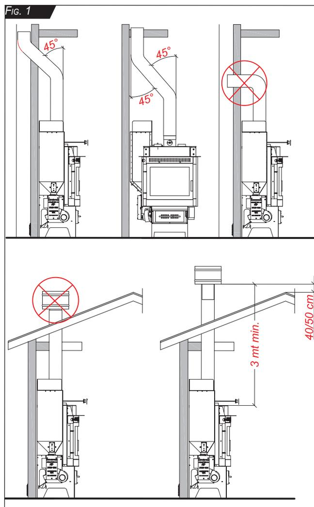
Ne pas utiliser des éléments à contre-pente. La connexion à le conduit de fumée doit permettre la récupération de la suie, le nettoyage à l'aide d'un écouvillon et être ramonable. Le raccord doit être de section constante. Il est possible d'adopter une section différente par rapport à celle préconisée uniquement au niveau de la sortie du générateur; il est interdit d'utiliser des réductions au branchement avec le conduit de fumée.
