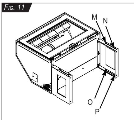
2. Disposez les prises d'air comme indiqué ci-dessous en fonction du type de prélèvement de l'air de combustion choisi.
